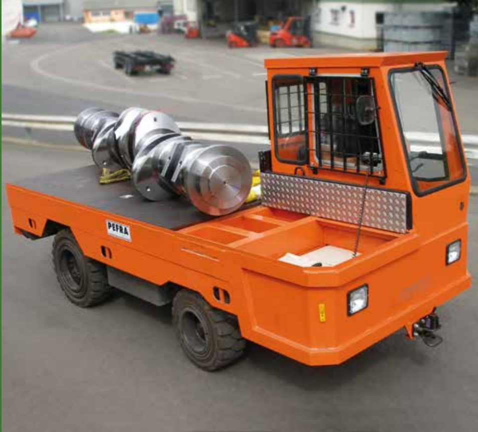
EGW: 8 t , Transport von Kurbelwellen Umsetzen von Abrollcontainern für Wertstoffe
