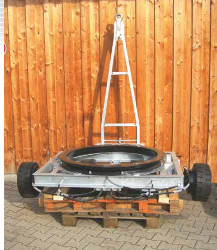
Schwerlastfahrgestell: 7 t, mit Drehschemellenkung Schwerlastfahrgestell
