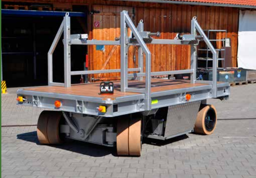
Modell 40868600 EGW: 35t, Transport von Presswerkzeugen
