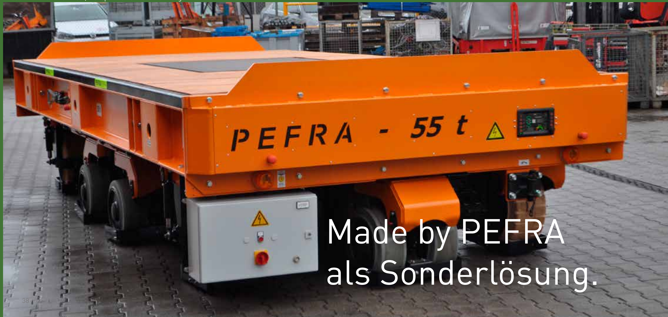
Modell 40784800 EGW: 55t, Transport von Umformwerkzeugen
