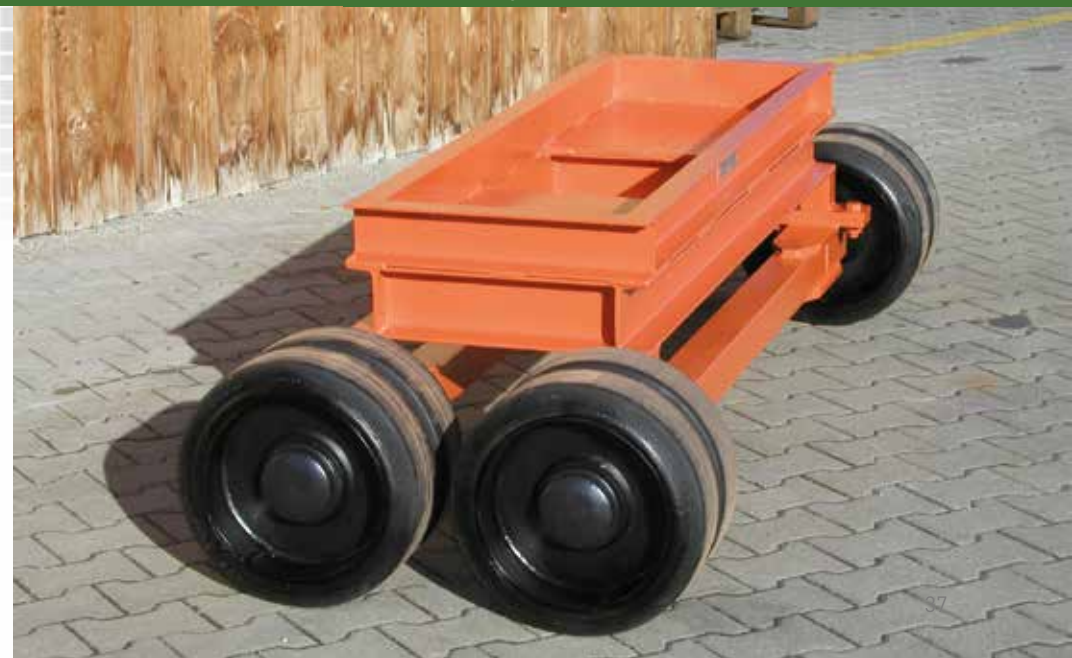
Schwerlastfahrgestell: 7 t, mit Drehschemellenkung Schwerlastfahrgestell
