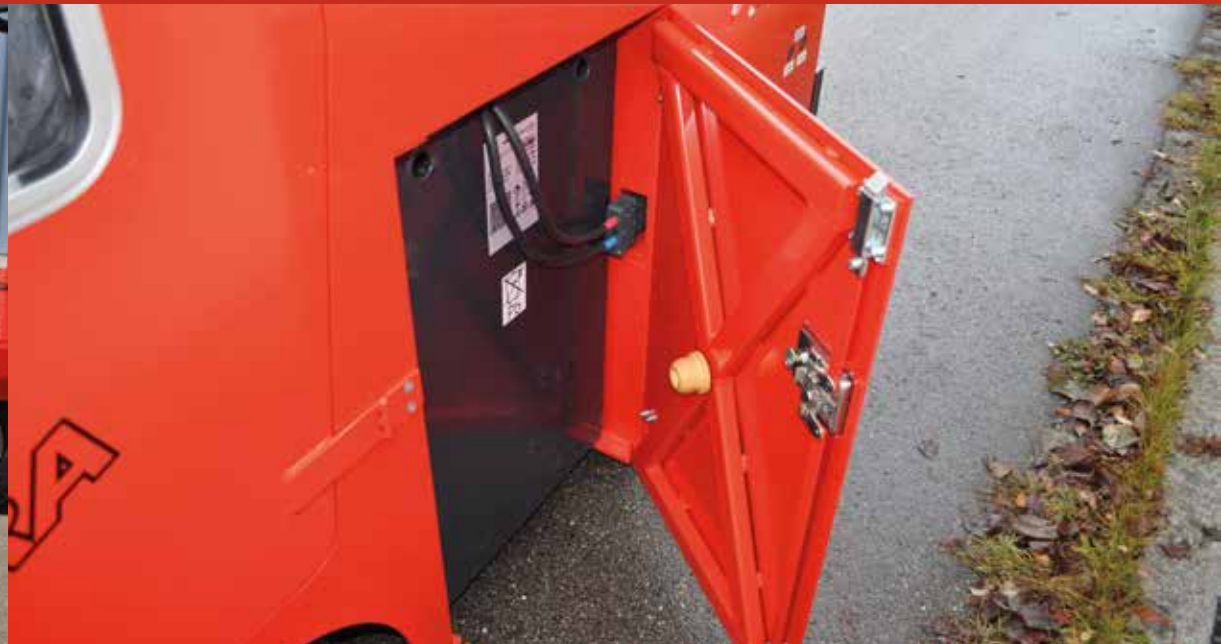
Modell 720: Schneller Batteriewechsel über seitliche Öffnung im Rahmen
