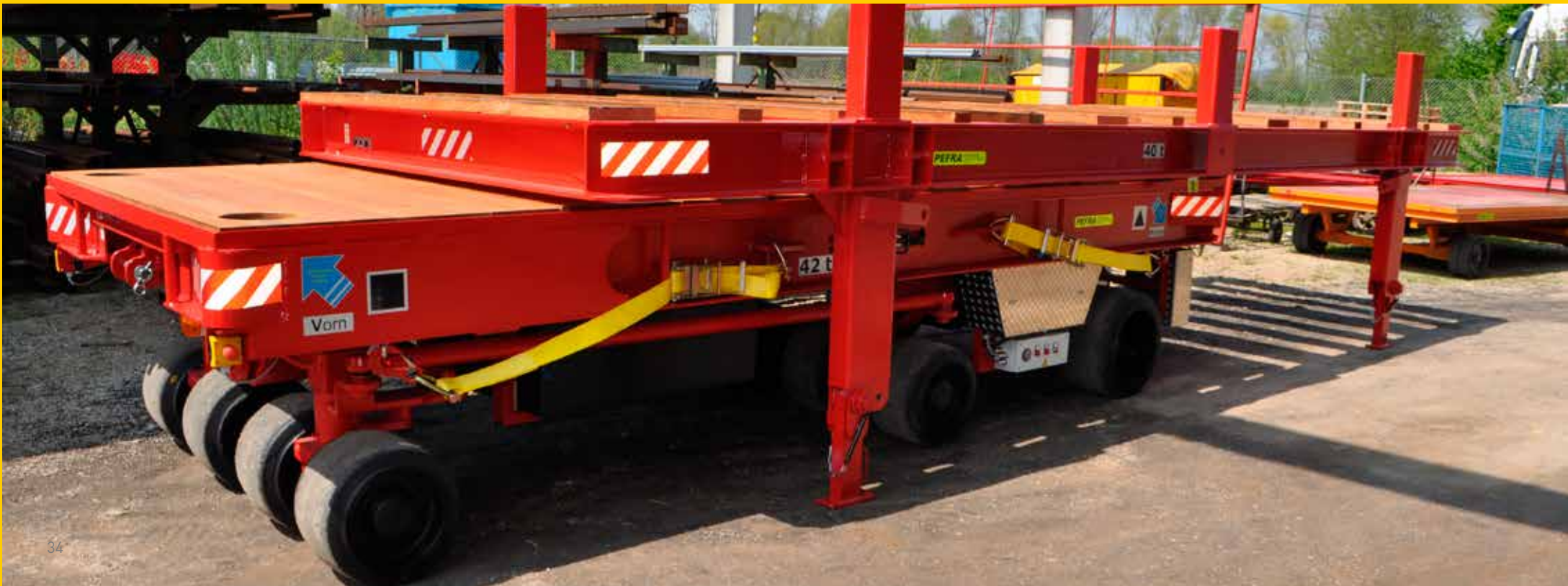
EGW: 42 t mit Wechselbrücke, Transport von Schmiedehalbzeug
