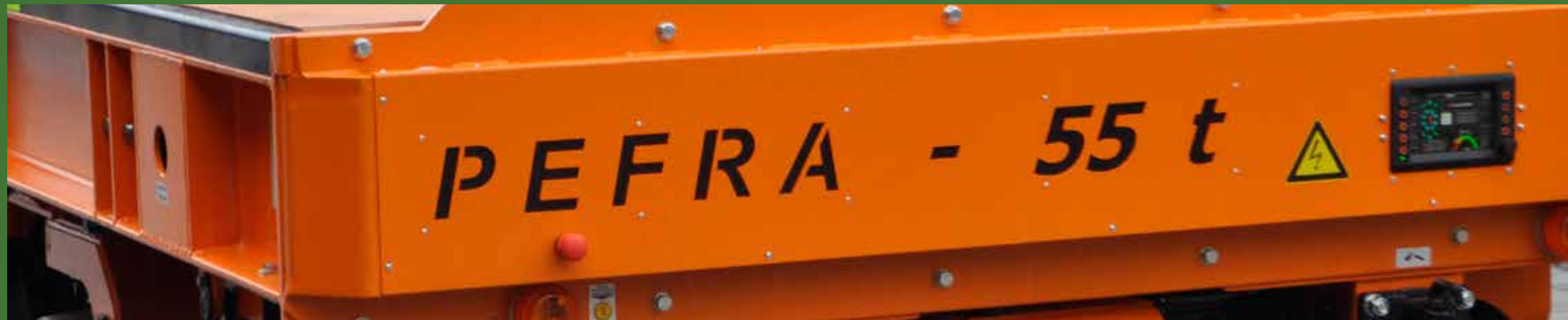
Modell 40784800 EGW: 55t, Transport von Umformwerkzeugen
