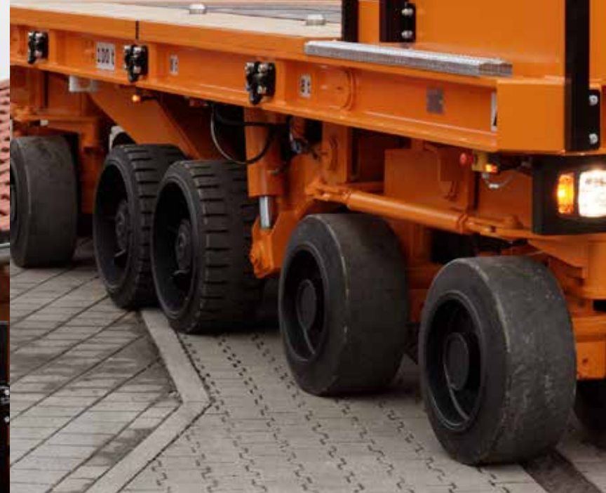
EFW: 100 t, Transport von Presswerkzeugen
