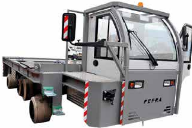
Bezeichnung: EFW Nutzl./Geschw.: 60 t/12 km/h Antrieb: 40KW 80V
