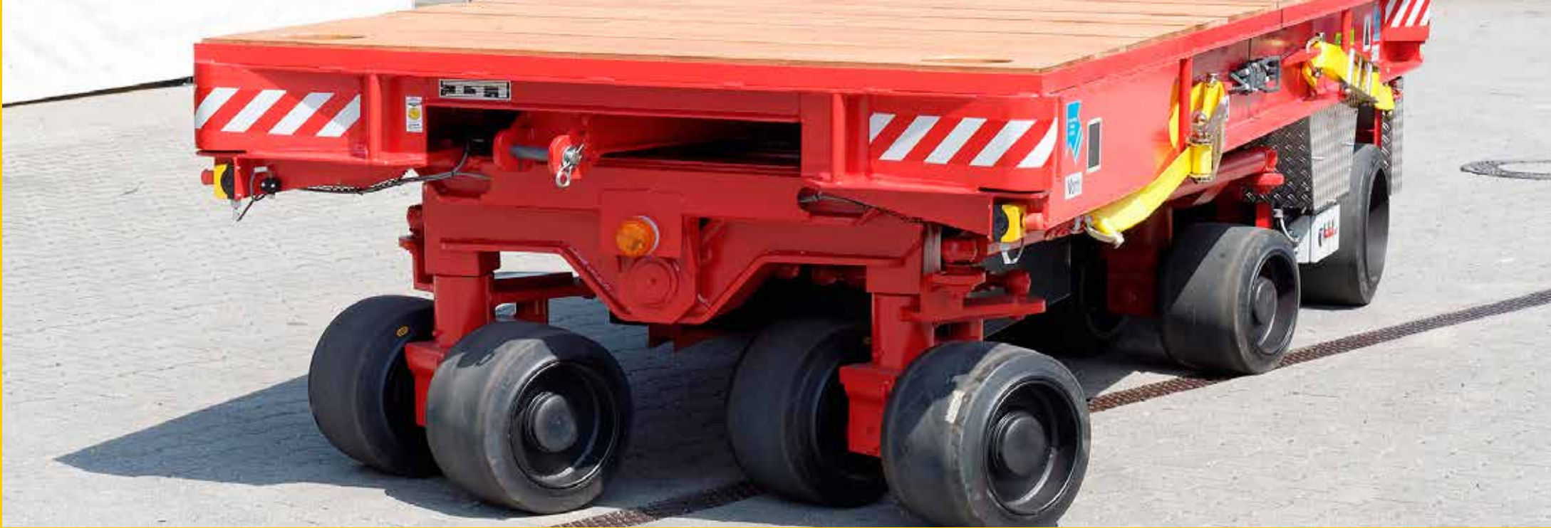
EGW: 42 t mit Wechselbrücke, Transport von Schmiedehalbzeug
