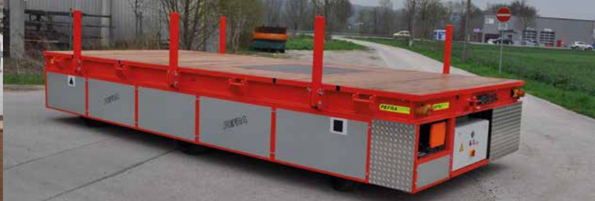
EGW: 20 t, Transport Stahlrohre (bis 18m)
