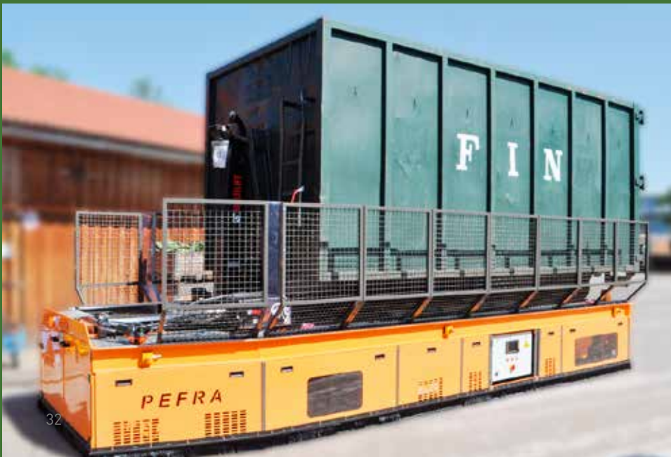
EGW: 8 t , Transport von Kurbelwellen Umsetzen von Abrollcontainern für Wertstoffe
