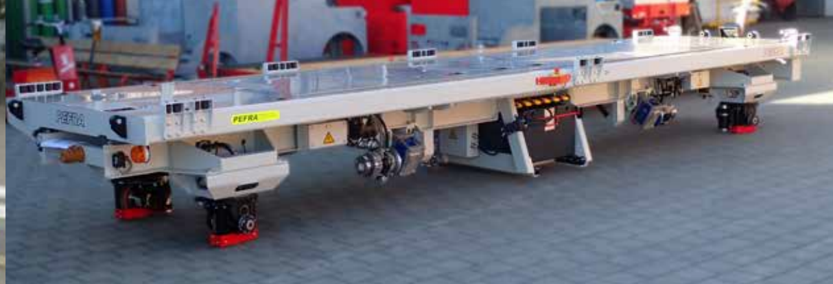
EGW: 2 t , Transport kundenspezifischer Tableaus (Formenträger)
