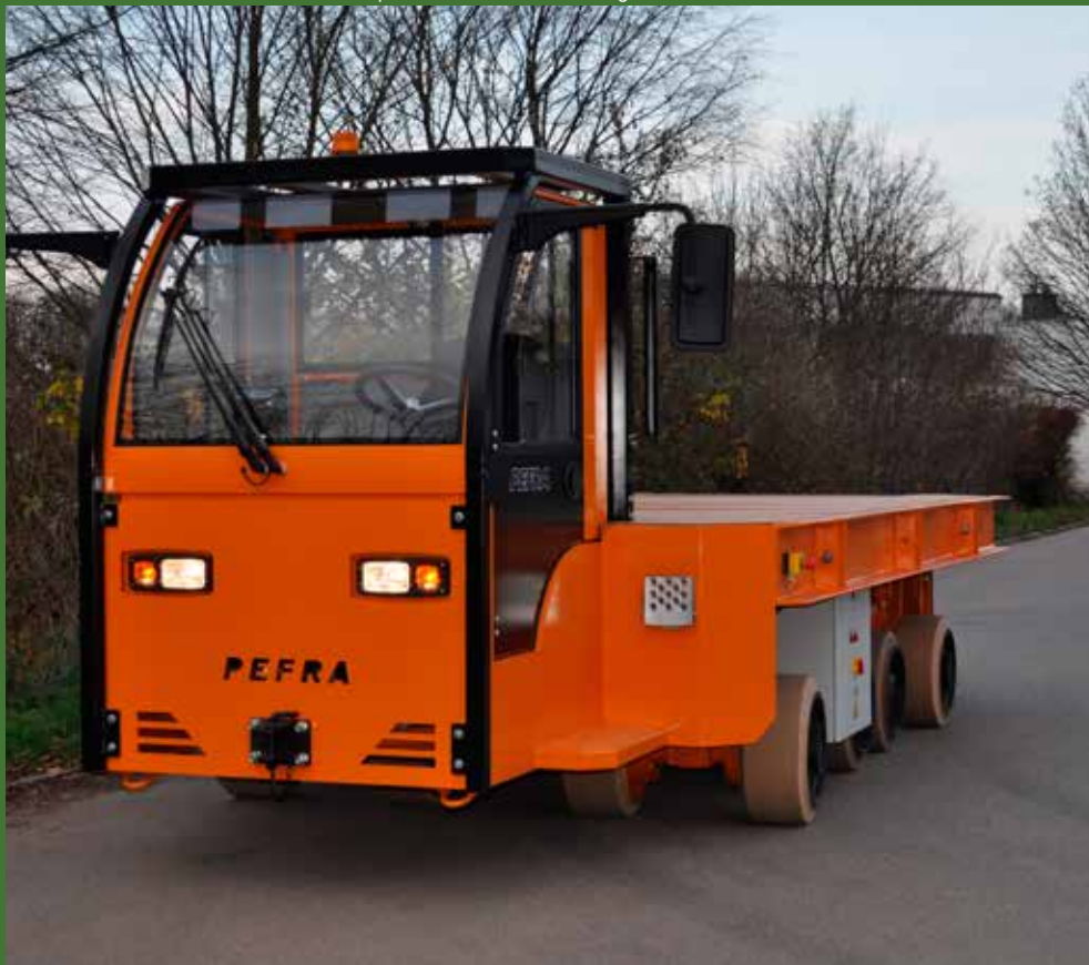
Modell 40868600 EGW: 35t, Transport von Presswerkzeugen
