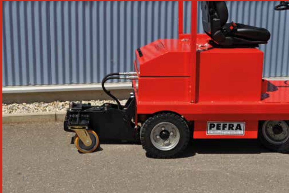
Modell 712 Rollpaletten: Palettenaufnahme - ohne Absteigen und trotzdem präzise und schnell
